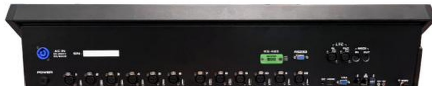
Panneau arrière de l'Auracue 245 — sorties DMX, connexions signal, et entrée d'alimentation True1
